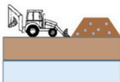
Réalisation de l'étrépage et de la mise en merlon
